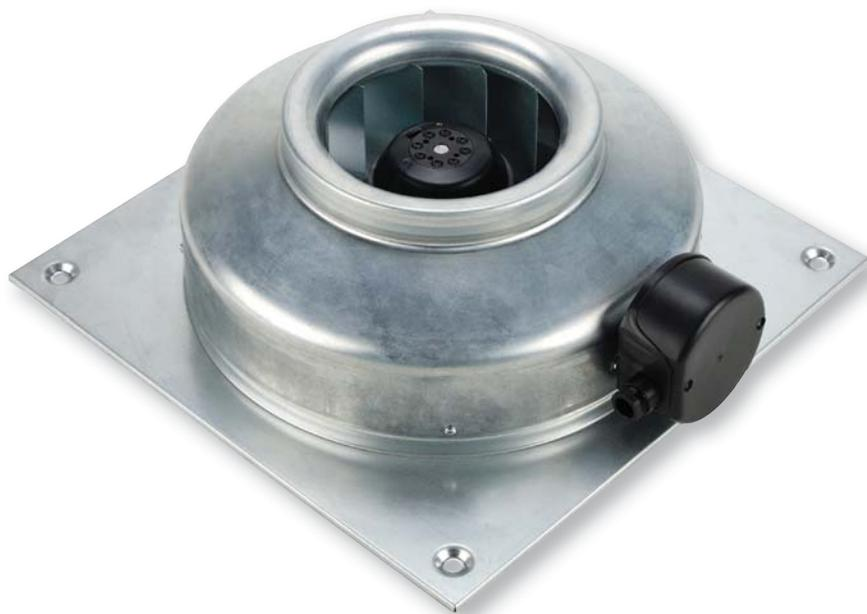
Вентиляторы для круглых каналов серии VENT-VN предназначены для настенной установки. Вентиляторы изготавливаются из оцинкованной листовой стали и оснащаются электродвигателями с внешним ротором и рабочими колесами с загнутыми назад лопатками. У моделей от 100 до 250 рабочие колеса изготавливаются из полиамида, а у модели 315 из оцинкованной стали.
