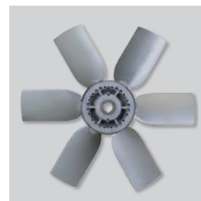
Динамически сбалансированная крыльчатка Крыльчатка динамически сбалансирована в соответствии с требованиями ISO 1940.
