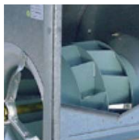
Рабочее колесо с загнутыми назад лопатками
