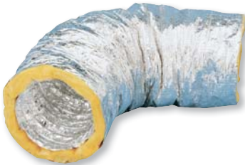
Класс огнестойкости: M0/M1 Минимальный радиус изгиба: 0,7 \times \varnothing Рабочие температуры: -10^\circ\text{C} \dots +150^\circ\text{C}
