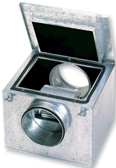
Вентиляторы в шумоизолированном корпусе из оцинкованной листовой стали с теплозвукоизоляцией из негорючего стекловолокна (М0) толщиной 50 мм. Крышка вентилятора крепится при помощи специальных защелок, которые обеспечивают плотное прилегание крышки к корпусу вентилятора. Вентиляторы комплектуются центробежными рабочими колесами с загнутыми вперед лопатками. Рабочие температуры от -20°C до +40°C.
